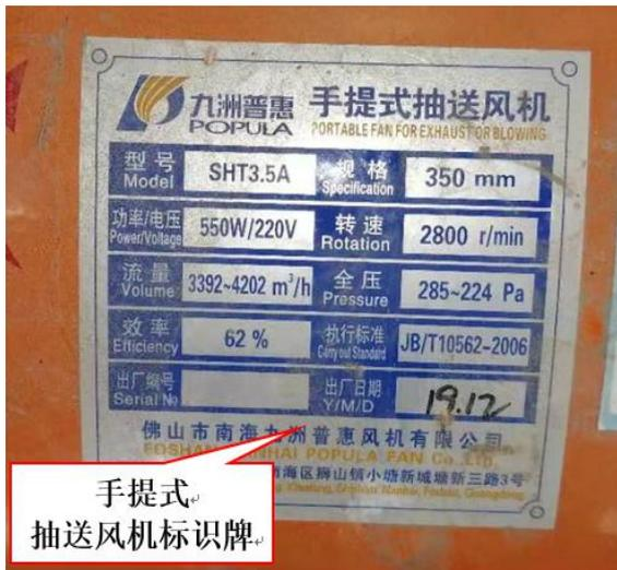
图 15 手提式抽送风机参数勘查图
